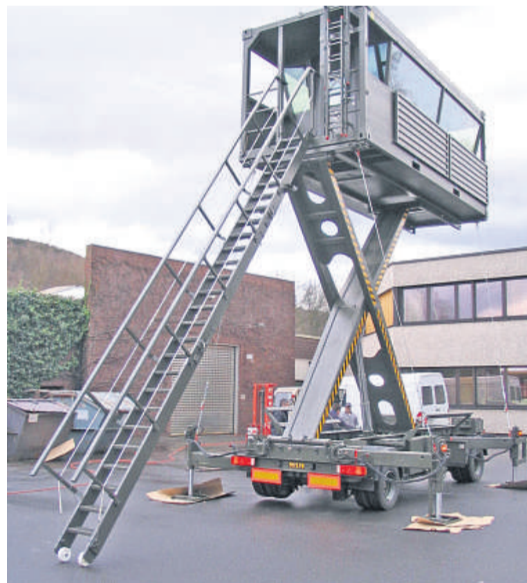
Für den Übergang: Mobile Tower kommen zum Einsatz, wenn ein bestehender Turm neu gebaut oder der Flugplatz zeitlich begrenzt genutzt wird.
